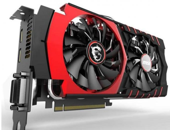
На данный момент нет никакой официальной информации о наличии у MSI GeForce GTX 970 фабричного разгона. В основу видеокарты положен графический процессор Maxwell GM204, выпускаемый по нормам 28 нм техпроцесса. Чип видеокарты GTX 970, скорее всего, будет иметь тысячу шестьсот шестьдесят четыре шейдерных процессора (CUDA), сто тридцать восемь текстурных блоков и тридцать два блока растеризации. GPU общается с четырьмя гигабайтами видеопамяти по 256-битному интерфейсу.
