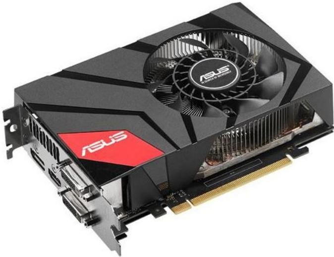
Новинка имеет длину всего 170 миллиметров. Охлаждением занимается инновационный кулер DirectCU, комбинирующий в себе испарительную камеру и вентилятор CoolTech. По словам производителя, он создает широкоугольный поток воздуха и отлично охлаждает критически важные комплектующие видеокарты. Согласно исследованиям Asus, эффективность данного кулера больше референсного на двадцать процентов. Кроме того, он работает значительно тише, чем стандартная система охлаждения NVIDIA.
